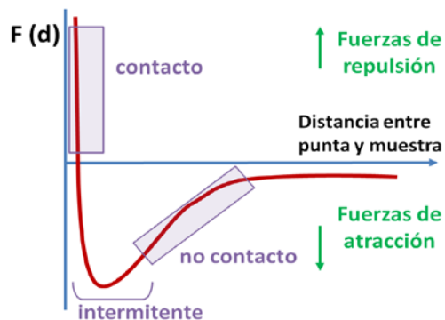
Figura 2.3. Curva de fuerza en función de la distancia de separación entre la punta y a la muestra. Se muestra en qué zona de la curva operan los modos contacto, no contacto e intermitente.
